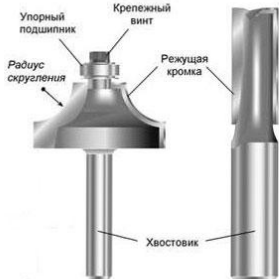
Строение фрезы по дереву
