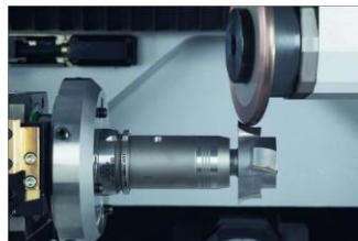
4 этап: Окраска и заточка твердосплавных лезвий
