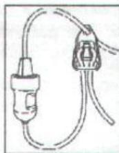
Проверьте соответствие напряжения питающей сети данным, указанным на маркировочной табличке изделия (допускается отклонение от указанных значений  $\pm 10\%$ ), и работу выключателя на холостом ходу.
